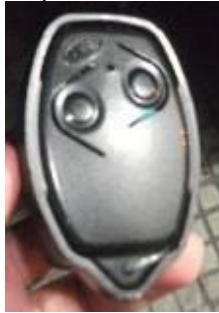
Figura 3: Controle para acionar abertura do portão
